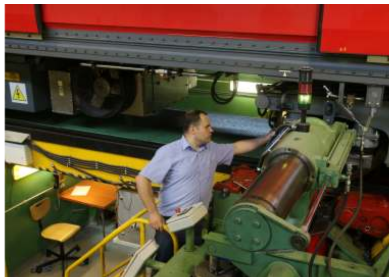
Kamil Bober wyjaśnia zasady działania tokarki podtorowej. Postęp procesu toczenia kół jest na bieżąco śledzony na monitorze komputera
