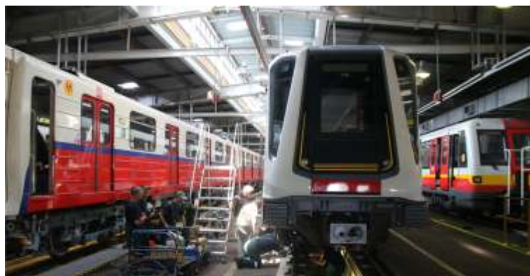
Prace przeglądowe oraz część naprawczych wykonywane są na miejscu – w elektrowozowni STP Kabaty. Pracownicy regularnie sprawdzają stan zespołów mający wpływ na bezpieczeństwo ruchu oraz wymieniają szybko zużywające się elementy
