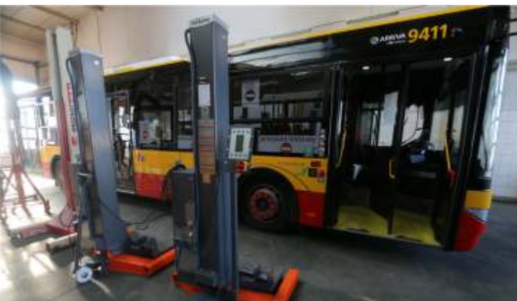
Zaplecze techniczne Arrivy – podnośniki umożliwiają regularny przegląd i naprawy taboru
