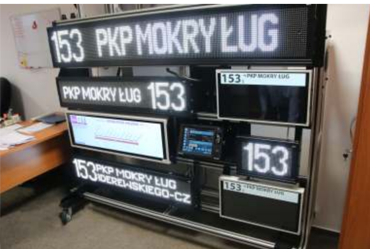
Stanowisko testowania systemu informacji liniowej w siedzibie ZTM. Dopiero po przetestowaniu wszystkich systemów rozpoczyna się certyfikacja pojazdu wzorcowego
