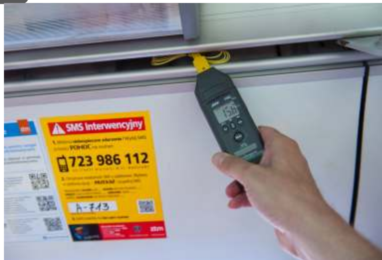
Pomiar temperatury w autobusie. Zimą temperatura w pojazdach komunikacji miejskiej powinna być utrzymywana w przedziale 5-15 stopni Celsjusza
