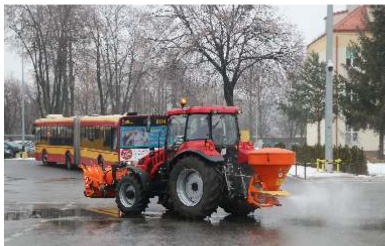
Traktor z pługiem i posypywarką soli – zimą niezbędny zestaw w zajezdni, aby autobusy mogły sprawnie wyjeżdżać w trasy
