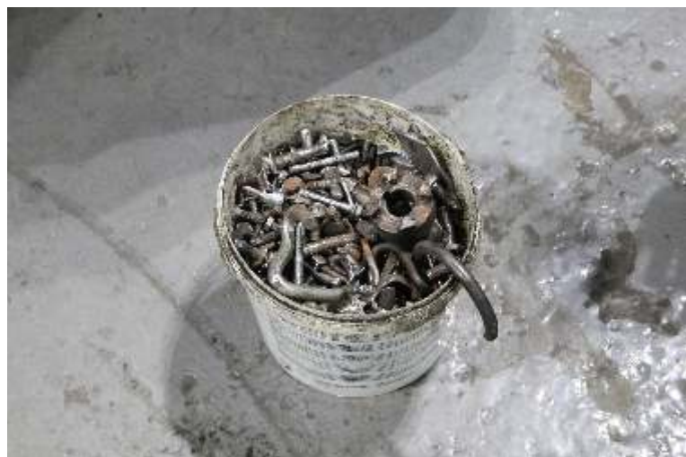
Śruby, nakładki, elementy łożysk – to wszystko usunięto z opon autobusów
