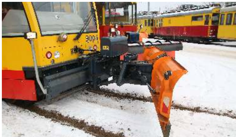
Najnowszy pług powstał na specjalne zamówienie – można go przesuwac, aby dokładnie odsnieżyć tuki torów
